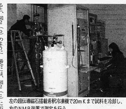
左の超伝導磁石搭載希釈冷凍機で20mKまで試料を冷却し、右のNMR装置で測定を行う
